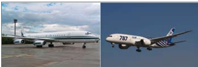
Abb. 4: Luftversorgung im Flugzeug Die Entnahme der Kabinenluft vor den 1960er-Jahren erfolgte außerhalb der Turbinen. Die Verlegung hatte rein aerodynamische Gründe. Letztes Flugzeug ohne Zapfluft war die Douglas DC-8 (1958-1972) (Foto: Mike Vallentin). Die Boeing 787 „Dreamliner“ ist zur Zeit das einzige moderne Flugzeug, was ohne Bleed Air System auskommt (Foto: Spacaero2 2011).
